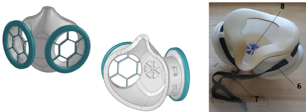
Figura 3. Diseño de mascarilla facial reutilizable con un filtro adecuado a las necesidades de protección contra la COVID-19.
