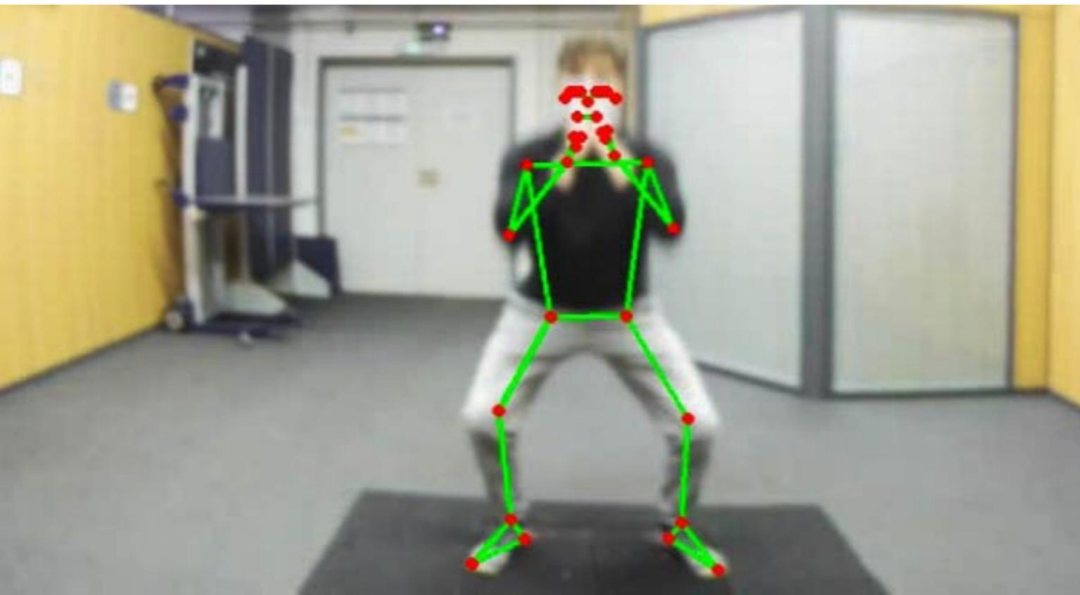
Figura 3. Ejemplo de captura de movimientos mediante el empleo de redes Open Pose, con la detección de diferentes puntos y segmentos corporales.
