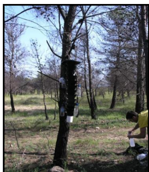
Figura 8: Trampa lindgren o multiembudo.
