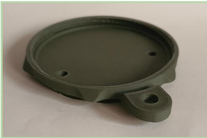
Variar la posición de la pieza al procesar el modelo hace que el tiempo y el peso se modifique, en esta pieza la variación es de media hora y 9 g de material.
