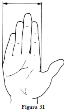
El diámetro del agujero interior donde se van a situar los componentes debe tener una amplitud mínima de 97 mm, situándose en el percentil 95, para que la mayoría de usuarios puedan acceder al fondo sin que su mano choque con las paredes. Como la profundidad del cuerpo no es muy alta el diámetro seleccionado permitirá a todos los usuarios llegar al fondo del cuerpo rosca hembra sin dificultades .
