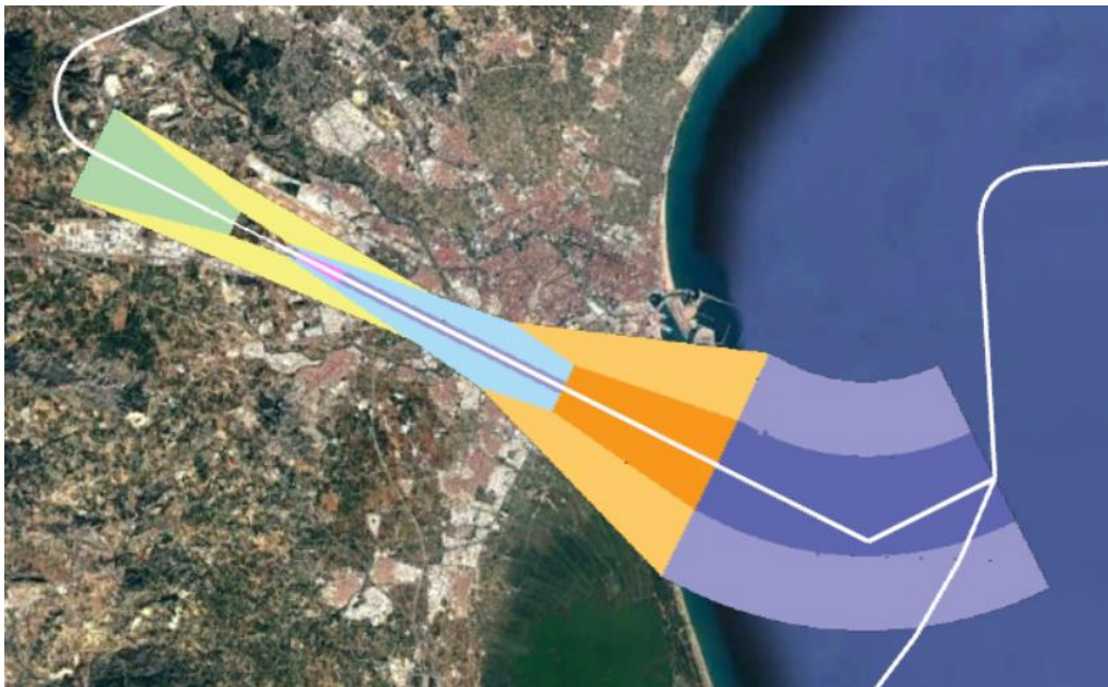
Ilustración 10-10: Áreas de protección de la aproximación para pista 12R en Google Earth, elaboración propia
