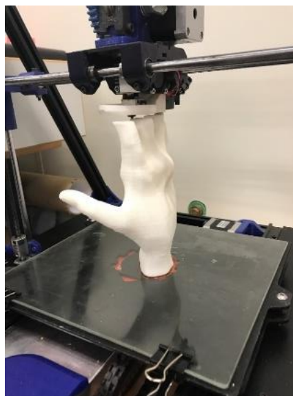
Figura 1. Proceso de impresión 3D de mediante el uso la técnica de fundición de plástico construyendo capas sobrepuestas para crear el objeto. IMPRESORA 3D BCN3D
