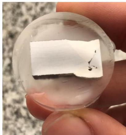
Es importante tener en cuenta durante el proceso, que este ha de realizarse siempre con agua y con la cara a desbastar lo mas paralela posible al disco, con el fin de no achaflanar la pieza, ya que sin una superficie totalmente plana, obtendremos imágenes parcialmente difusas cuando las observemos con el microscopio. Para que esto sea más fácil, debemos simplemente apoyar
