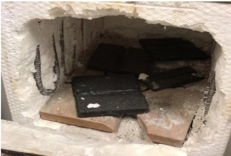
Una vez precalentada, se extrae del horno y mientras se coloca cuidadosamente en la mesa de trabajo y se amarra con los gatos sargento, la temperatura baja hasta los 400° aproximadamente, que comprobamos con un medidor laser.
