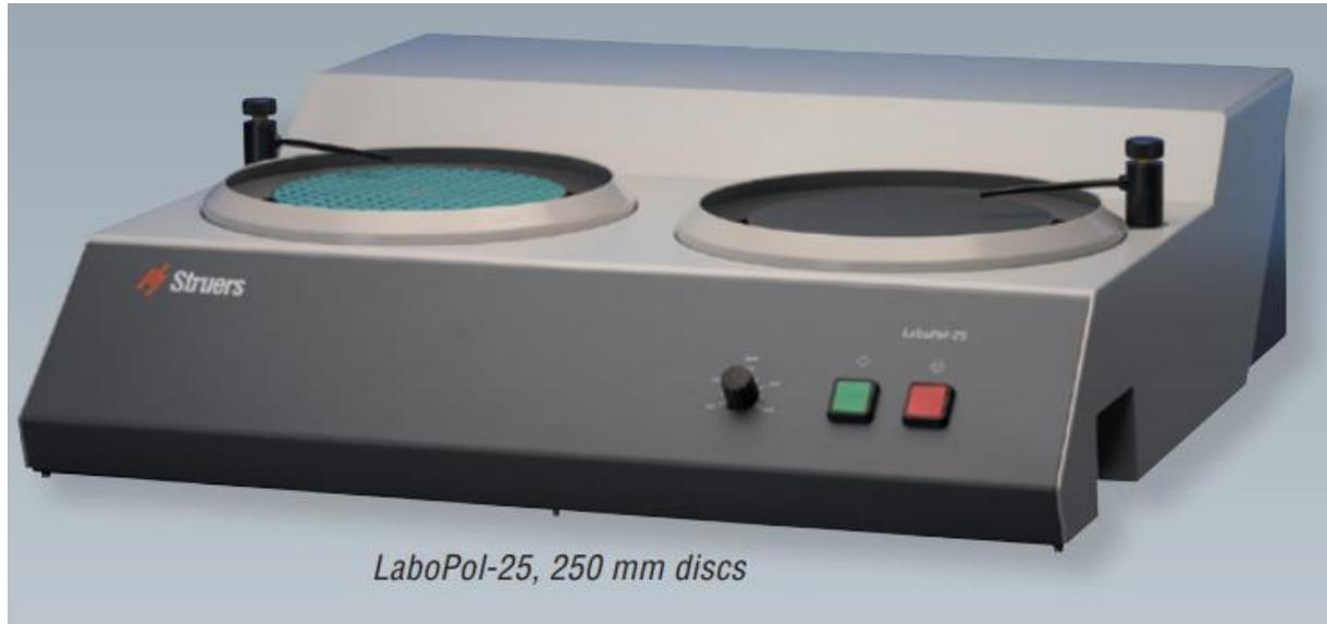
En primer lugar, pasamos la probeta por el disco con un papel de grano 180, para que quite las marcas más profundas. Posteriormente, haremos el mismo proceso, pero utilizando granos más finos, de 400 y de 1000. En las imágenes puede apreciarse como va cambiando el aspecto de la probeta a medida que desbastamos.
