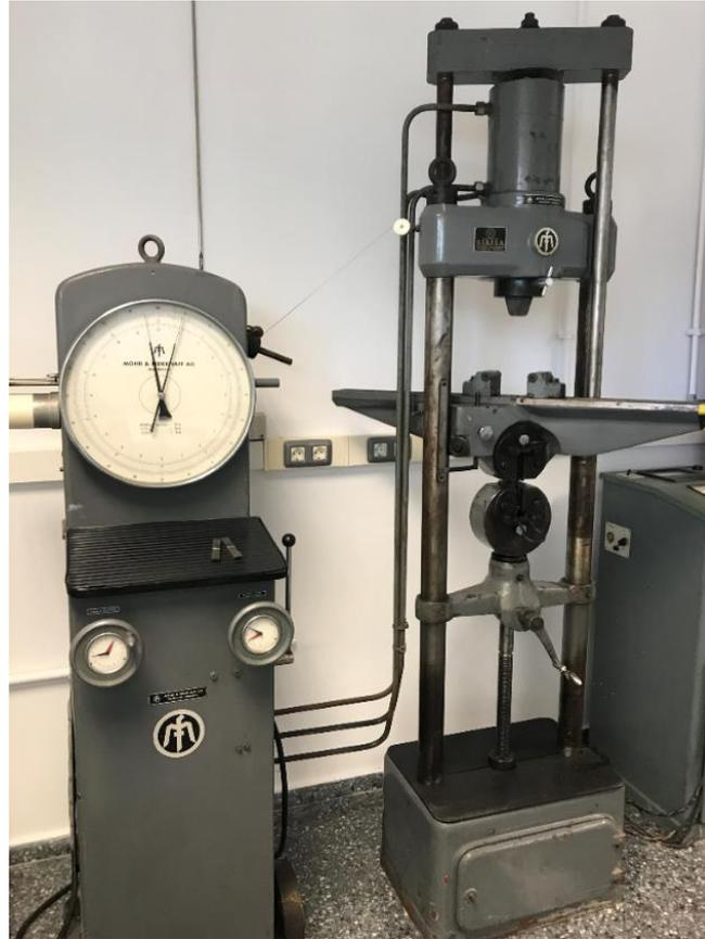
La maquina consta de dos cabezales con mordazas, para poder amarrar la probeta de ambos extremos y someterla al esfuerzo de tracción. El cabezal inferior es fijo y el superior recibe el esfuerzo del hidráulico ejerciendo la presión que se le ordena desde la palanca de accionamiento.
