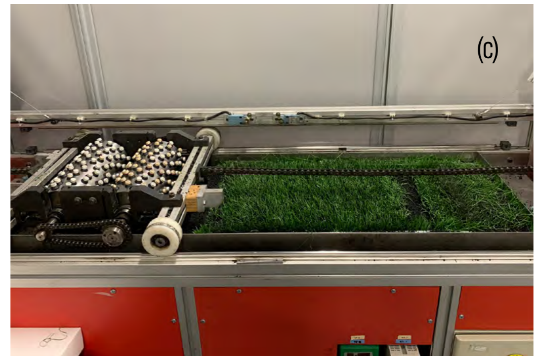
Figura 5. Moqueta empleada para las pruebas de elasticidad antes de someterse a fatiga (a) y después de fatiga (b). Detalle de la máquina LISPORT empleada para fatigar las muestras (c).
