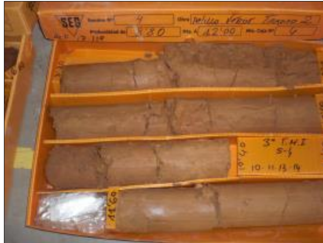
Figura 5-12: Sondeo 8.8-12m. (Fuente: Estudio geotécnico)
