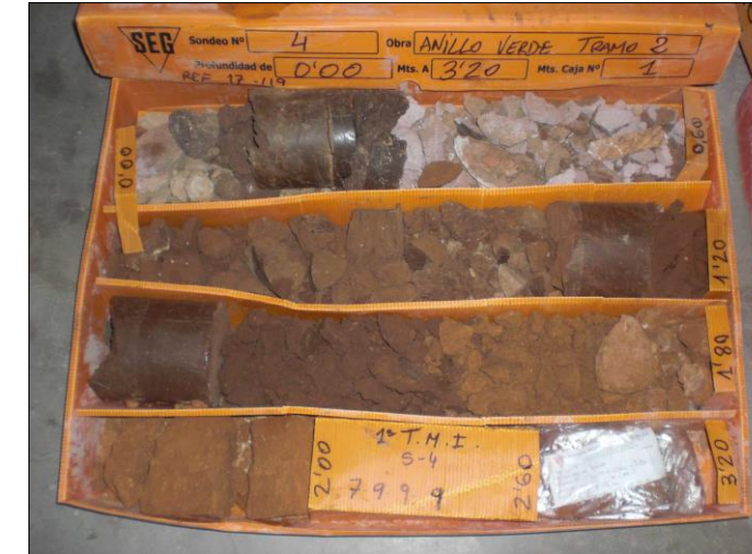
Figura 5-10: Sondeo 0,00-3,2m. (Fuente: Estudio geotécnico)
