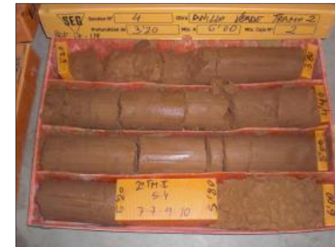
Figura 5-11: Sondeo 3,2-6m. (Fuente: Estudio geotécnico)
