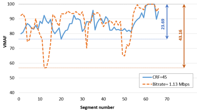
Figura 1.19. Comparación del VMAF de cada segmento del vídeo “Elephants Dream” codificado a calidad constante (CRF 45) y bitrate constante (1,13 Mbps).
