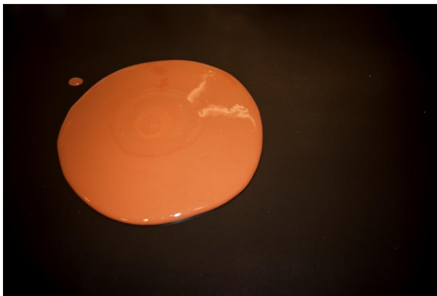
Fig. 9 Dispersión de suelo illítico con 10% de agua de amasado, pH9 y %0,01 AG.
