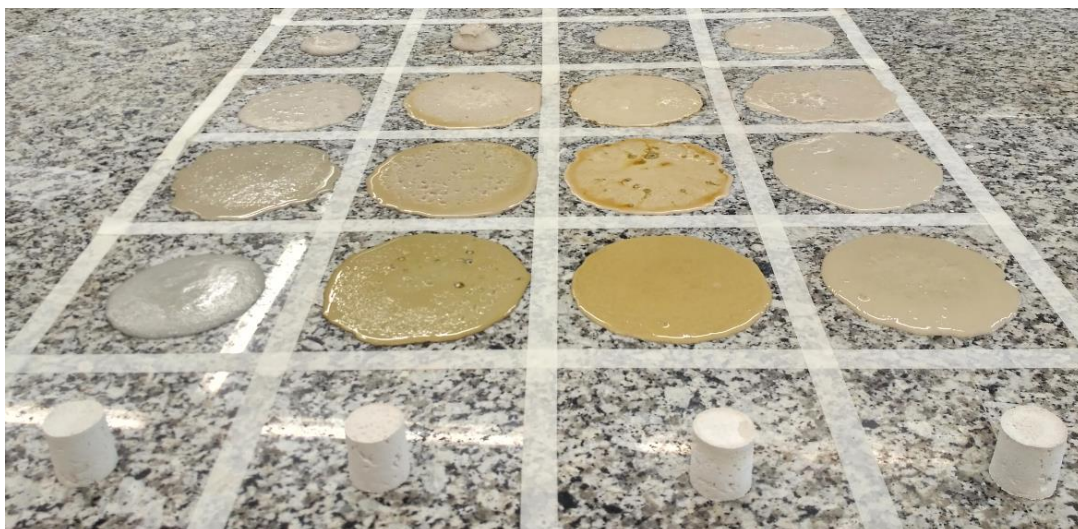
Fig. 8 Cuadro de reacciones en el suelo caolínítico en distintos % de aditivo y pH con el % H_2O demi constante.
