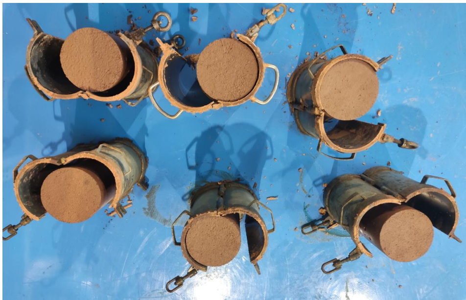
Fig. 11 Preparación de especímenes de ensayo para rotura a compresión vertical ( F_{cm} ).
