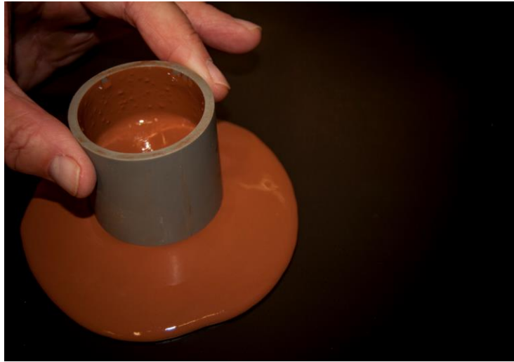
Fig. 1 Revestimiento de arcilla illítica en consistencia líquida mediante dispersión.
