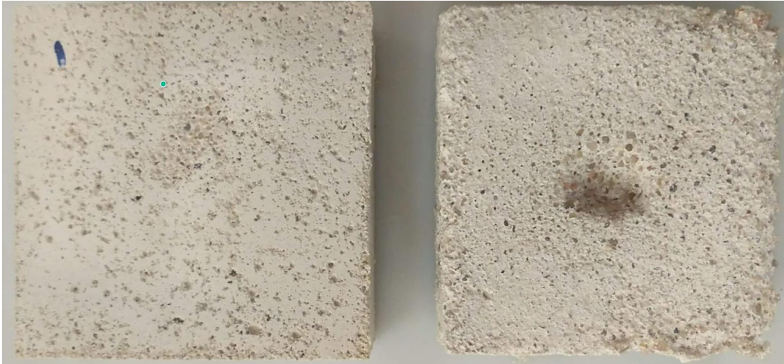
Fig. 10 Ensayo de abrasión hídrica mediante ensayo SAET.
