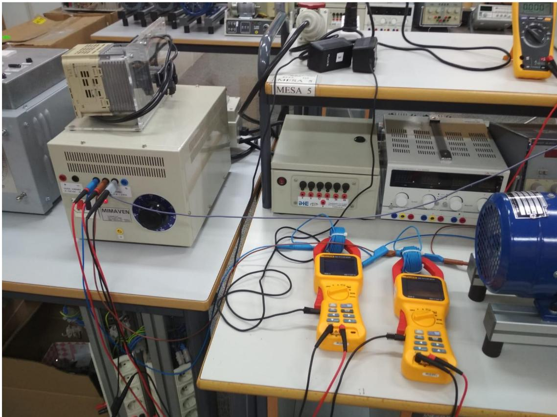
*Figura 7.1 Ensayo de verificación de los circuitos equivalentes*
