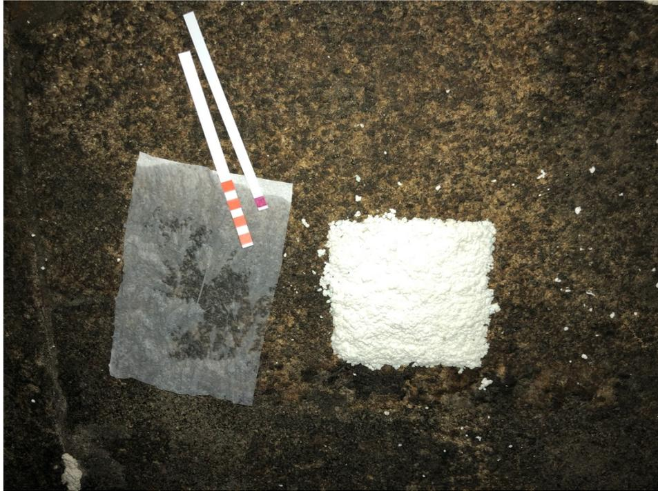
**Figura 6. Determinación de la presencia de sales sobre el pavimento de la capilla.**
