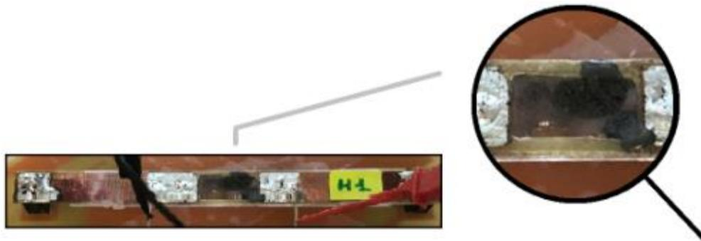
Figura 34. Muestra con partículas de  $FeO_2$  (tamaño entre  $5\mu m$  y  $8\mu m$ ) con la concentración 1, formada por 140mg de partículas y 5.5mg de aceite.
