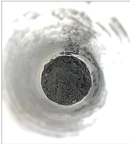
Figura 16.a Partículas de carbonil de hierro,  $\text{FeO}_2$  (tamaño entre  $5\mu\text{m}$  y  $8\mu\text{m}$ )
