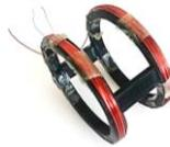
Figura 44. Bobinas Helmholtz para la excitación de corriente de la muestra.
