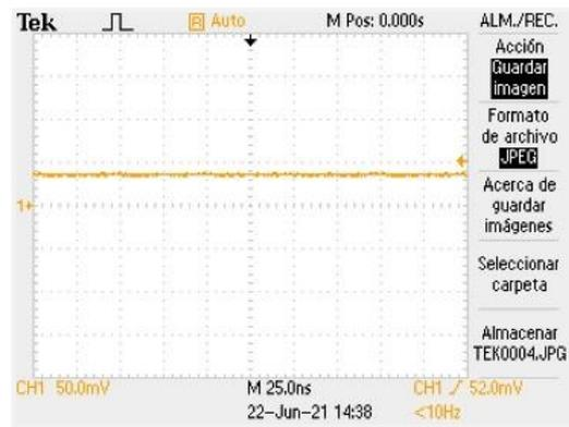
Figura 49.b. Imagen capturada mediante el osciloscopio a la salida del filtro paso bajo.
