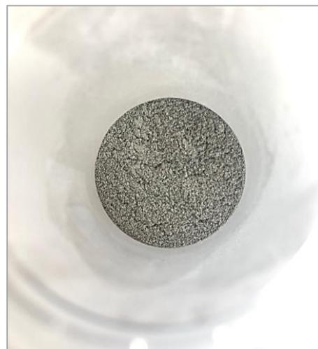
Figura 16.b. Partículas de hierro, Fe (tamaño entre  $50\mu\text{m}$  y  $80\mu\text{m}$ ).
