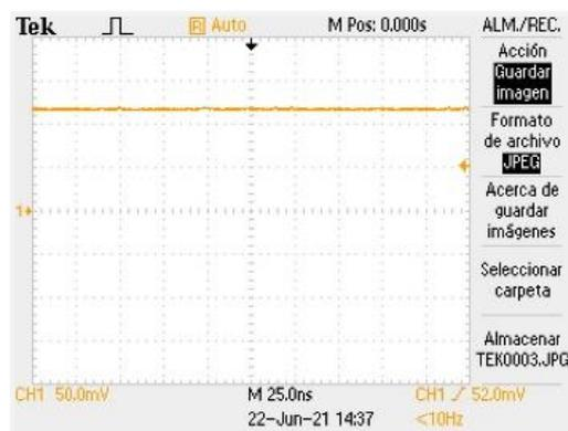
Figura 51.b. Imagen capturada mediante el osciloscopio a la salida del filtro paso bajo.
