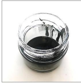
Figura 39. Tinta empleada para la variación de GMI formada por nanopartículas de tamaño entre 10nm y 90nm.
