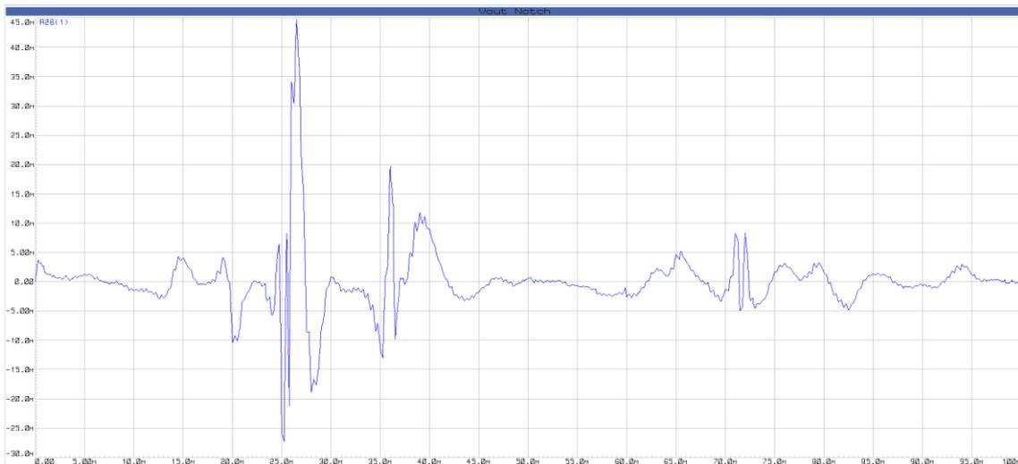
Figura 42: señal de salida del filtro Notch en el simulador.
