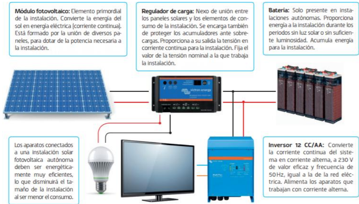
Ilustración 3: Elementos de una instalación solar fotovoltaica
