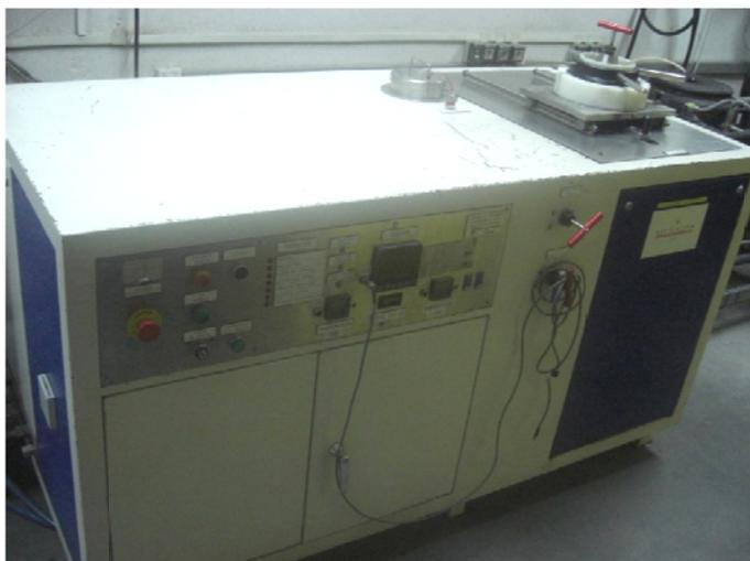
**Figura III.2.2.** Unidad de presión hidrostática empleada en el procesado de caqui y cebolla.
