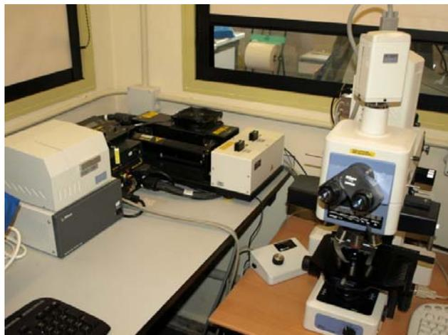
**Figura III.3.5.** Microscopio óptico Nikon Eclipse E800 V-PS100E con microscopio láser confocal Nikon C1 acoplado (Nikon, Tokio, Japón).
