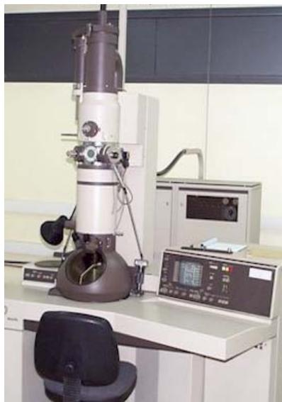
**Figura III.3.4.** Microscopio electrónico de transmisión EM 400 de Philips.
