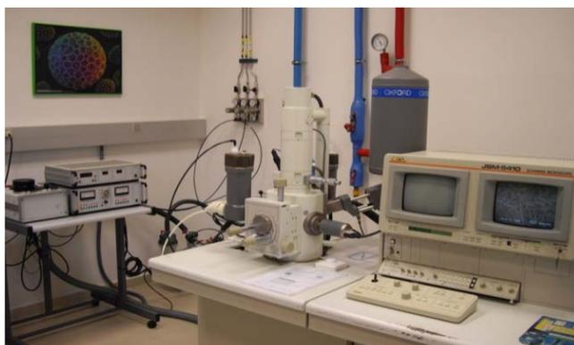
**Figura III.3.1.** Cryo-Trans CT1x500C de Oxford Instruments acoplado a un microscopio de barrido Jeol JSM 5410.
