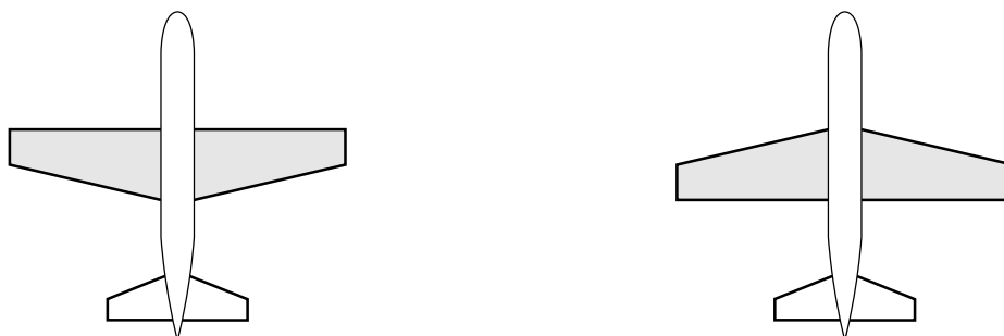
(a) Ala trapezoidal con borde de ataque perpendicular al eje de simetría de la aeronave
