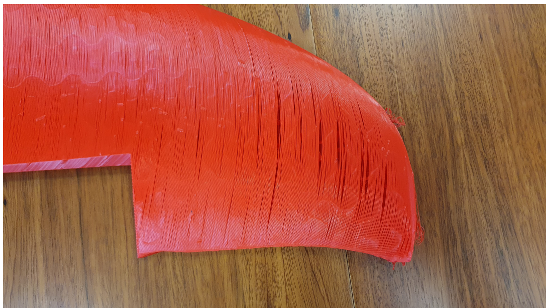
Figura 7.7: Enfoque de la punta del ala donde se aprecia el defecto detectado sobre la superficie de la pieza
