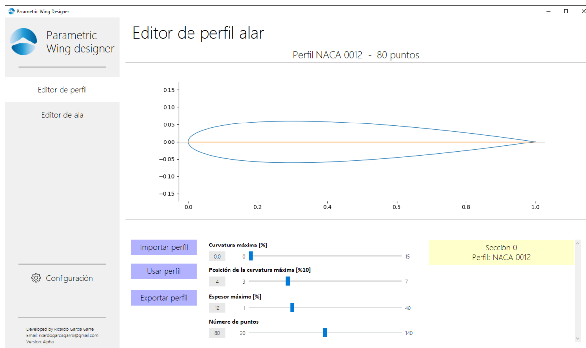
Figura 6.3: Aspecto de la pestaña del Editor de perfil alar al iniciar el programa
