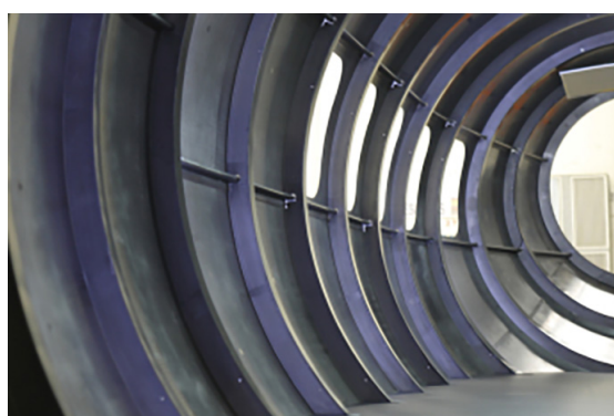
Figura 2.2: Interior del fuselaje TorresWing donde se aprecia el revestimiento y las cuadernas de fibra de carbono [6]
