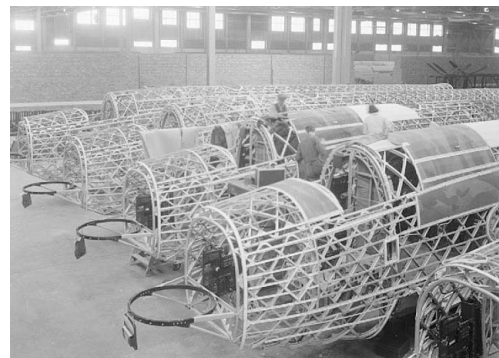
(b) Bombarderos Vickers Wellington bajo construcción [4]
