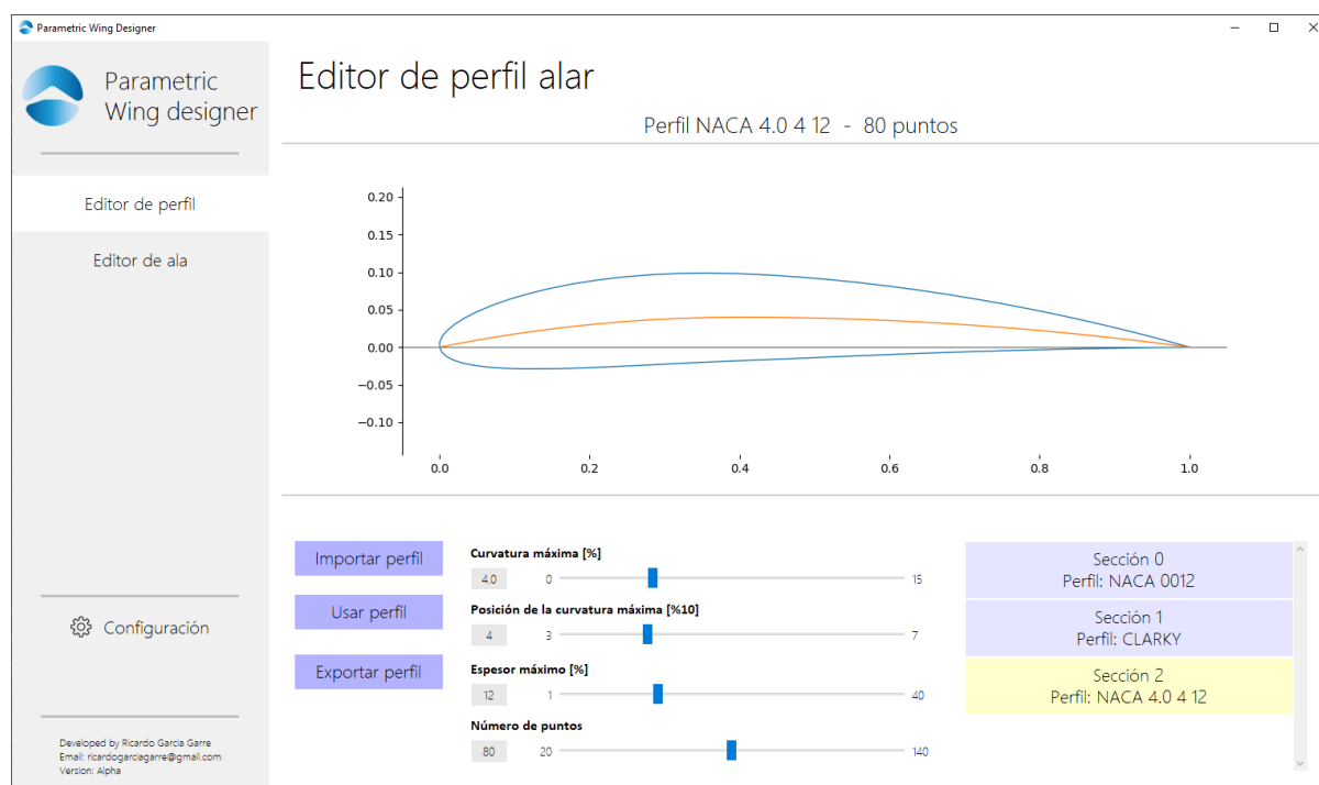
Figura 6.4: Ejemplo de uso de la pestaña del Editor de perfil alar que contiene tres secciones y se muestra la Sección 2 con un perfil NACA 4412
