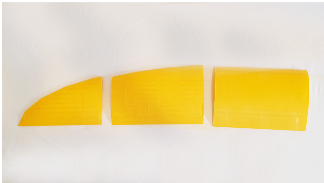
Figura 7.10: Resultado del proceso de impresión del semiala diseñada, seccionada en tres partes
