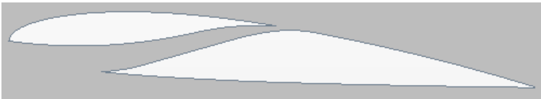
Figura 68: Geometría 1.5. Ejemplo de geometría con entrada adelantada y radio de entrada aumentado
