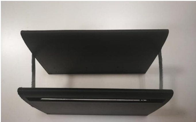
Figura 15: Modelo de impresión 3D de la geometría de biplano con slot
