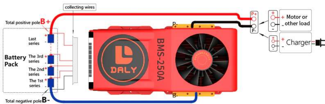
Ilustración 50 BMS Daly Cableado
