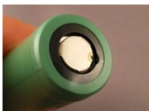
Ilustración 8 Celda con una quemadura superficial
