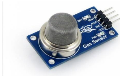
Figura 2. 6: Sensor de calidad del aire MQ-135
