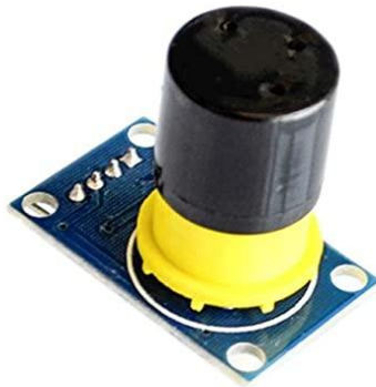
Figura 2. 8: Sensor detector de O_3 MQ-131
