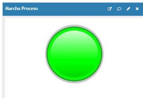
Figura 3. 8: Piloto para visualizar cuando está funcionando el proceso
