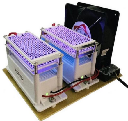
Figura 2. 21: Generador de ozono con sistema de ventilación
