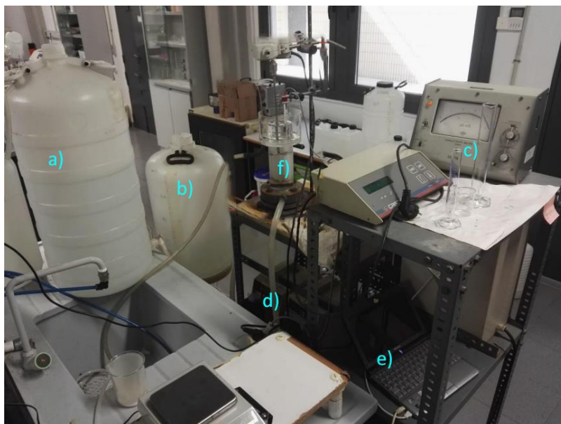
Figura 2: Montaje experimental de la planta piloto: a) Bidón de 60 L de HCl, b) Bidón de 50 L de agua de red, c) Conductímetro, d) Bombas peristálticas, e) Ordenador portátil, f) Tanque químico agitado
