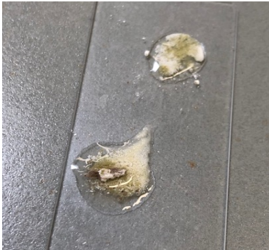
Fig.44: Reacción del ácido clorhídrico sobre una muestra con pigmento verde
