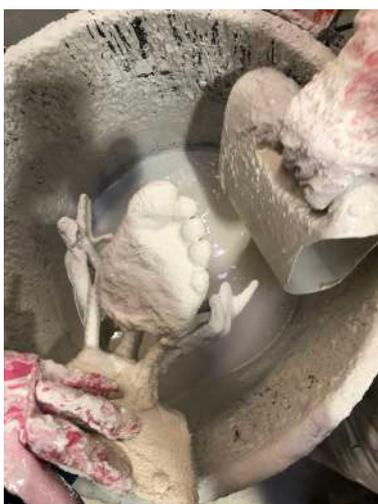
**Fig. 21.** Baño de las piezas de mediano formato en sílice coloidal. 2021.
