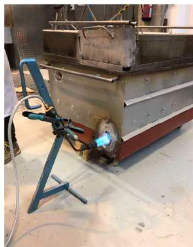
**Fig. 23.** Calentamiento de la cama mediante el soplete. 2021.
