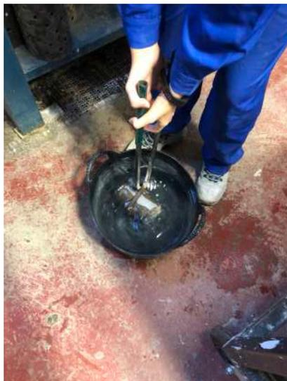
**Fig. 18.** Enfriado del cilindro introduciéndolo en el agua. 2021.
