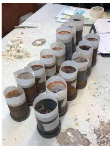
**Fig. 13.** Cilindros preparados para el vertido de revestimiento. 2021.
