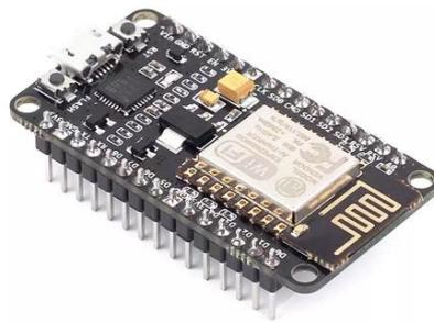
**Figura 17 Modulo NodeMCU microcontrolador ESP8266**
