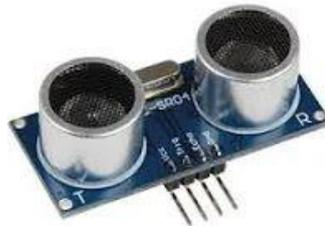
Figura 9 Sensor de distancia ultrasónico HC-SR04
