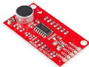
Figura 13 Detector de sonido SparkFun
