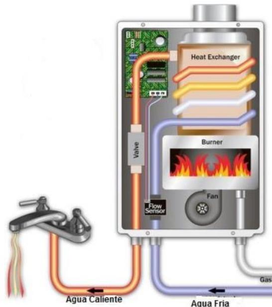
Figura 5. Esquema calentador de gas (<https://www.areatecnologia.com>, s. f.-a)
