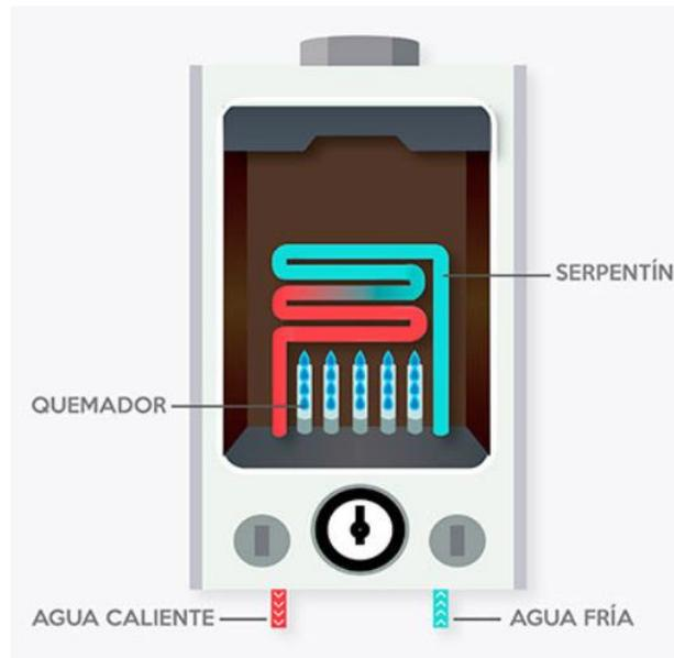
Figura 6. Esquema calentador de paso («¿Cómo funciona un calentador instantáneo?», s. f.)
