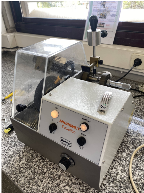
(a) Maquinaria para el proceso de corte con disco abrasivo
