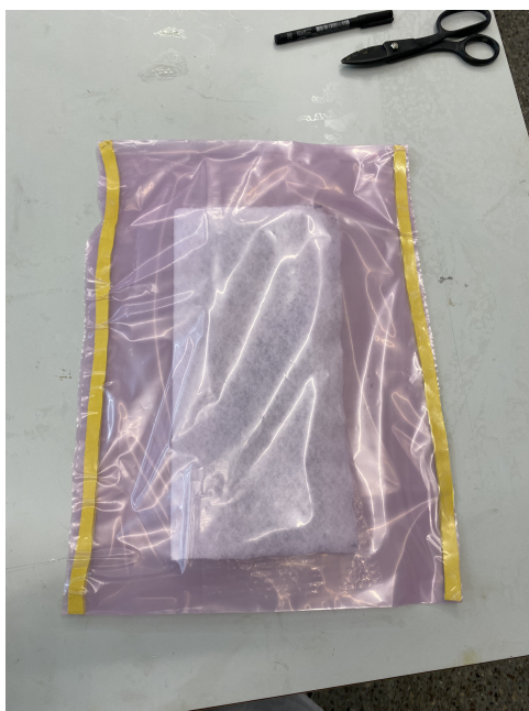
(a) Bolsa de vacío con peel plate
