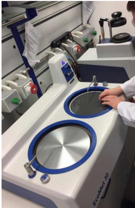
(a) Maquinaria para el proceso de desbaste [33]
