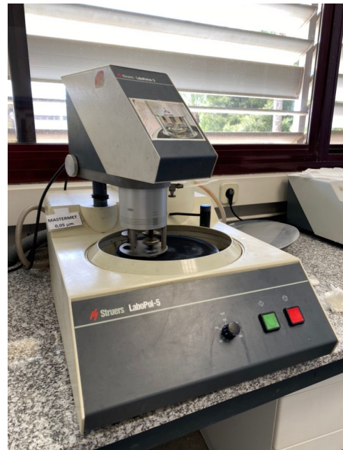
(b) Maquinaria para el proceso de pulido
