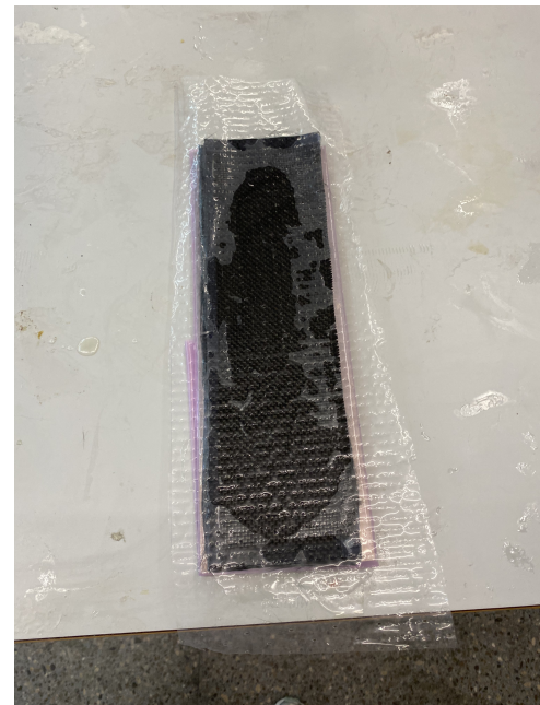
(b) Proceso de laminado del material compuesto
