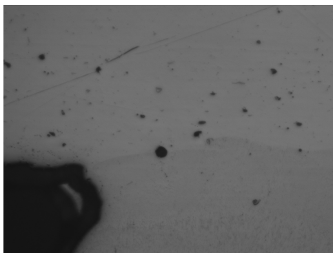
(a) Microestructura antes del ataque Weck
