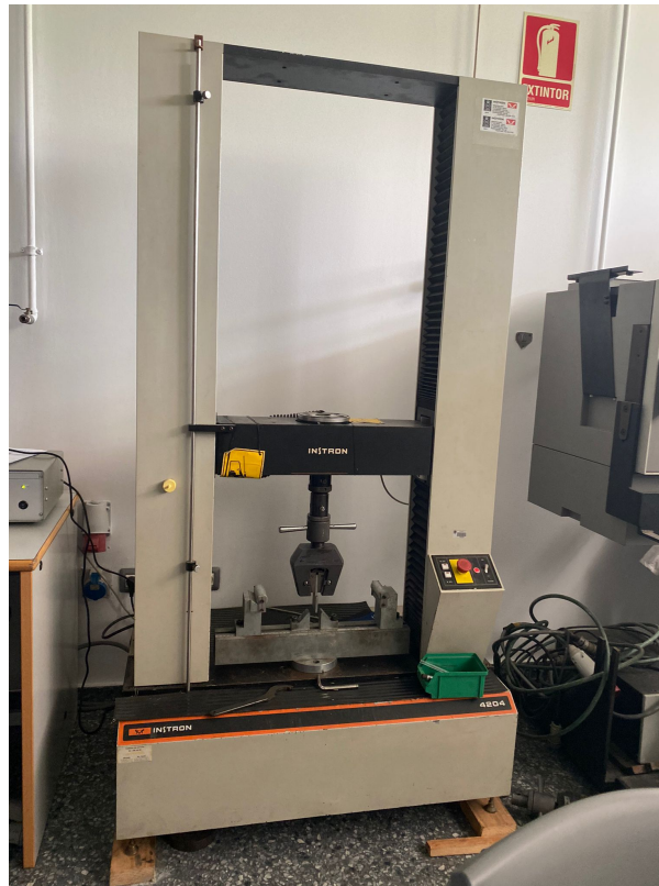
Figura 5.1: Máquina utilizada para el ensayo de flexión
