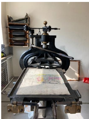
Figura 12. Prensa vertical de palanca. Realizada en la Facultad de Bellas Artes de la Universidad Politécnica de Valencia
