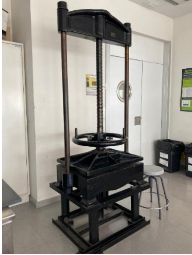
Figura 10. Prensa de Husillo. Realizada en la Facultad de Bellas Artes de la Universidad Politécnica de Valencia
