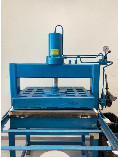
Figura 13. Prensa vertical hidráulica. Realizada en la Facultad de Bellas Artes de la Universidad Politécnica de Valencia
