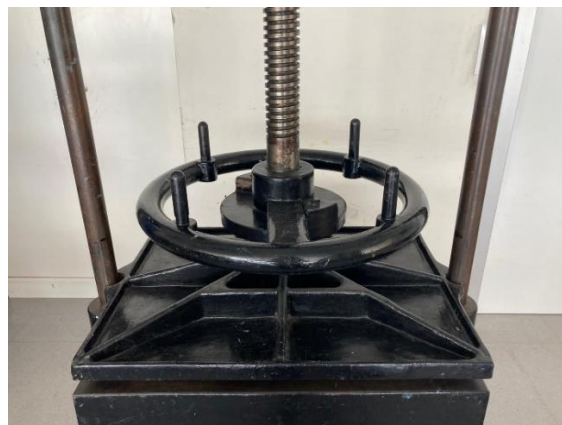
Figura 11. Detalle de prensa de Husillo. Realizada en la Facultad de Bellas Artes de la Universidad Politécnica de Valencia
