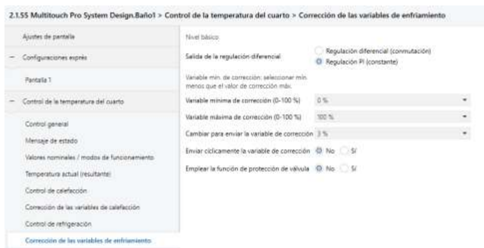
Fig.34 Multitouch, corrección de las variables de enfriamiento
