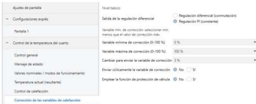
Fig.32 Multitouch, corrección de las variables de calefacción
