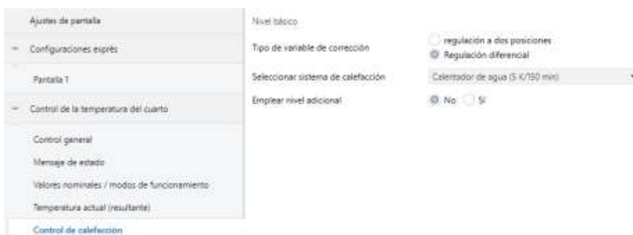
Fig.31 Multitouch, control de calefacción
