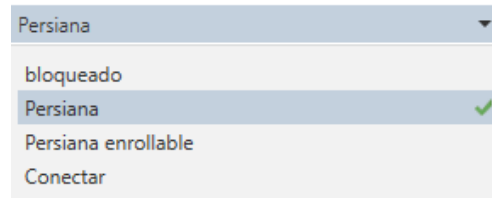
Fig.15 Actuador de persianas, modos de funcionamiento
