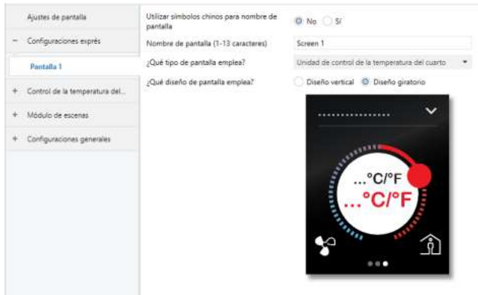
Fig.26 Multitouch, configuración exprés
