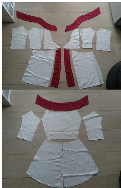
Figuras 40 y 41. Patrones del kimono de las partes delantera y trasera pasados a tela y recortados. Diana García García, 2021.
