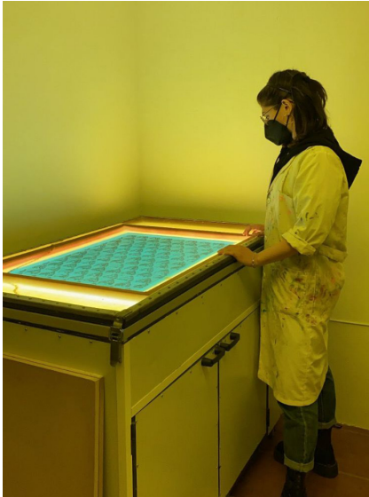
Fig. 34. Insolando con los fotolitos
