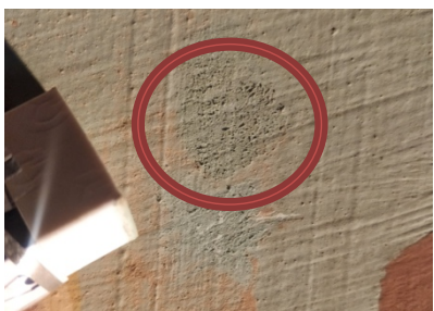
Img.59: Resultado de la cata de limpieza mecánica con goma Stadler Mars Plastic ®.
