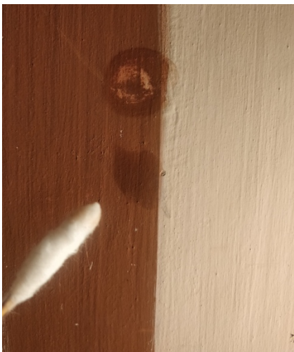
Img. 31: Cata de solubilidad, resultado del efecto del alcohol sobre la técnica pictórica.
