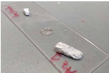
Img. 29: Ensayo de la gota de ácido clorhídrico (HCL).
