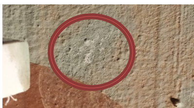
Img.61: Resultado de la cata de limpieza mecánica con goma Stadler Rasoplast ®.
