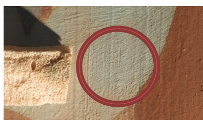
Img.63: Resultado de la cata de limpieza mecánica con goma de caucho.
