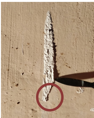
Img.66: Resultado de la cata de limpieza mecánica con escalpelo de punta de lanza.
