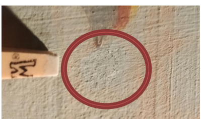
Img.60: Resultado de la cata de limpieza mecánica con goma Master Gum ®.
