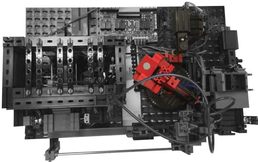
Figura 4: Zona de mecanizado de la Estación Multiproceso
