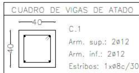
Ilustración 7.2-5. Viga de atado. (Fuente CYPE 3D).
