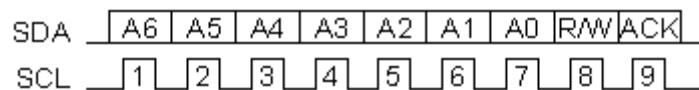
Figura 13. Información que contiene el primer byte que transmite el maestro en cada pulso de reloj (tomado de [11]).
