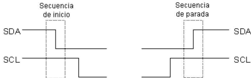
Figura 14. Secuencia de inicio y parada del protocolo I 2 C (tomado de [11]).
