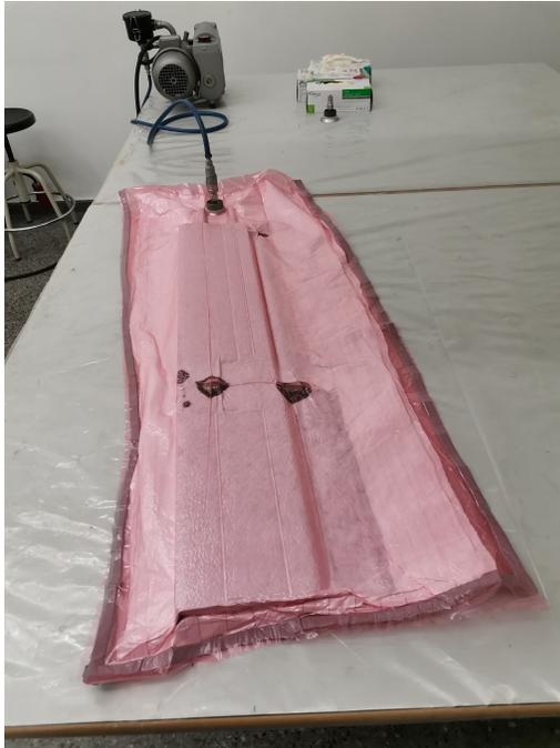
(a) Extracción del aire de la bolsa de vacío.
