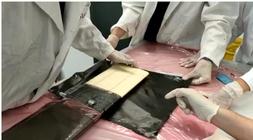
**Figura 1.20:** Centrado de la fibra sobre el núcleo de poliestireno.
