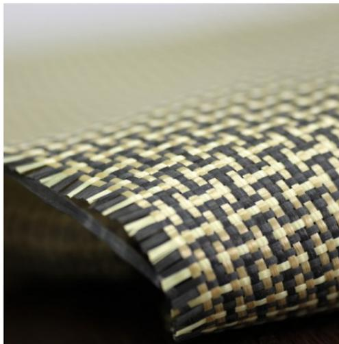
**Figura 1.13:** Tejido de fibra kevlar-carbono 5x4 3K comercializado por ClipCarbono [12].
