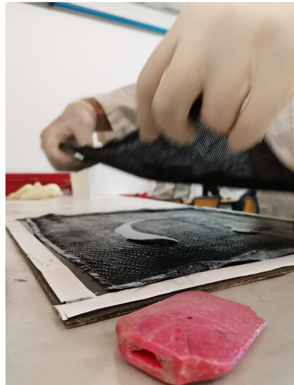
(b) Colocación de una capa de fibra sobre otra ya impregnada en resina.
