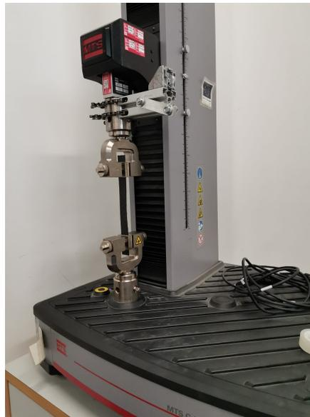
**Figura 1.28:** Máquina de ensayos MTS® C42.503 sometiendo una probeta de CFRP a tracción.
