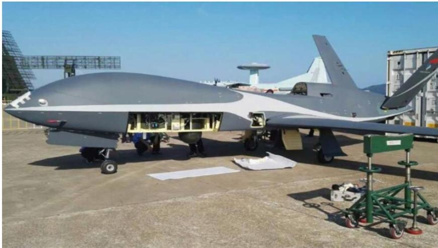
**Figura 1.1:** UAV **Cloud Shadow** fabricado íntegramente con materiales compuestos [2].
