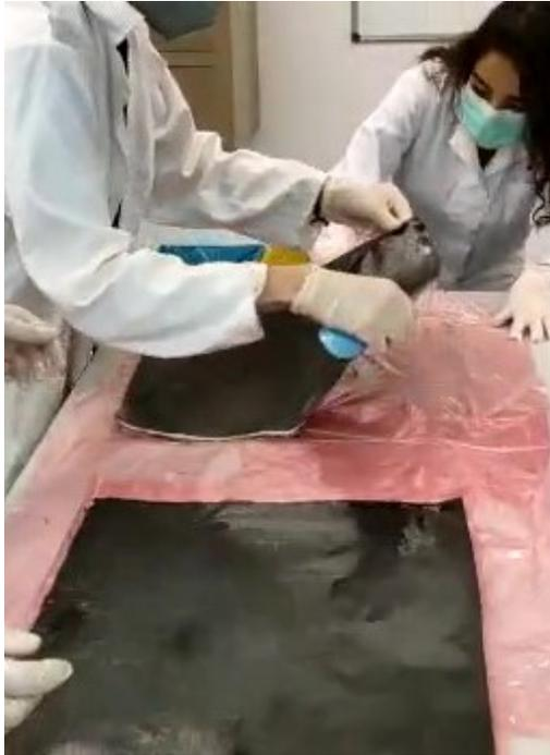
(a) Extensión de la fibra impregnada en resina sobre bolsa de vacío.
