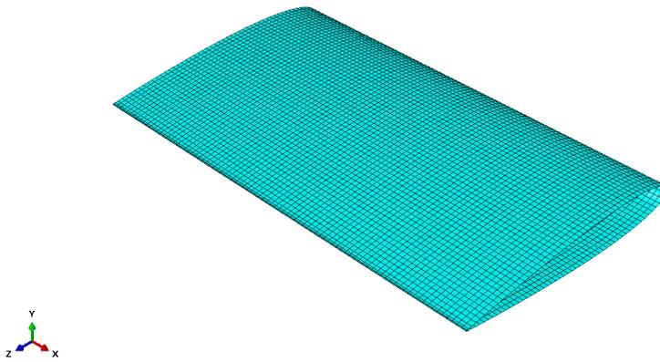
**Figura 1.48:** Mallado de la piel de la estructura.
