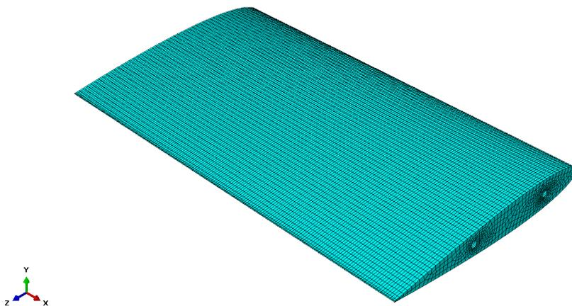
**Figura 1.49:** Malla impuesta en el core de poliestireno extruido.
