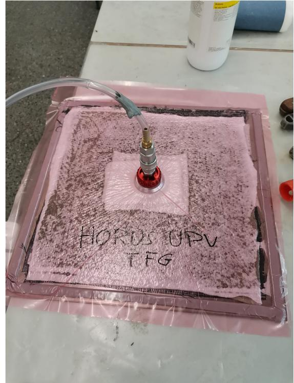
(b) Sellado de la bolsa y aplicación del vacío.
