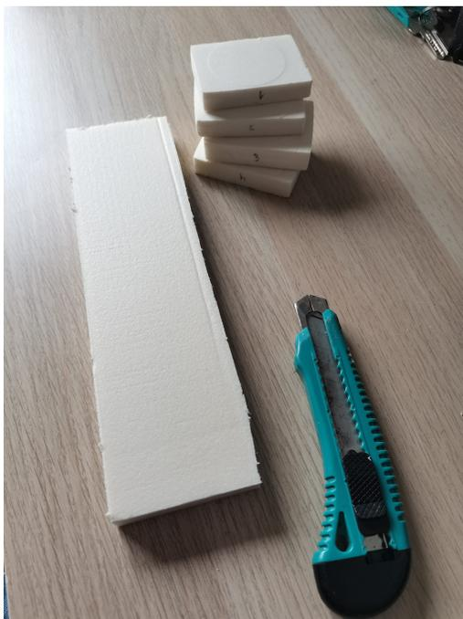
(a) Probetas utilizadas para el ensayo y preparación de la probeta para estimación de la densidad.
