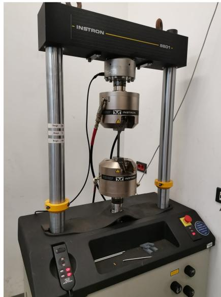
**Figura 1.26:** Máquina de ensayos **INSTRON® 8801**.
