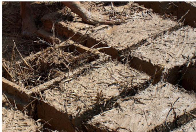
**Figura 1.7:** Proceso de fabricación del adobe, en el que se aprecia la matriz y el refuerzo [9].
