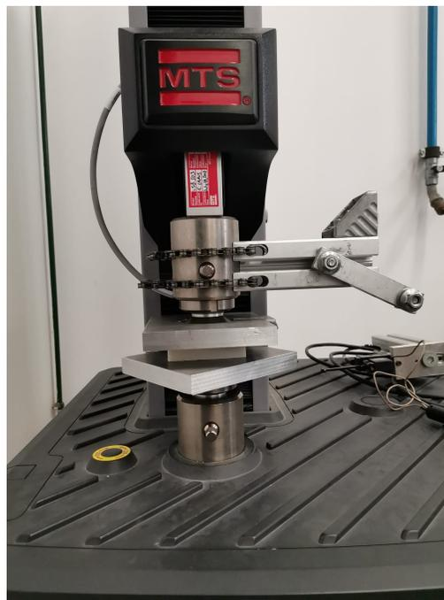
(b) Máquina de ensayos MTS® C42.503 comprimiendo una probeta de poliestireno.
