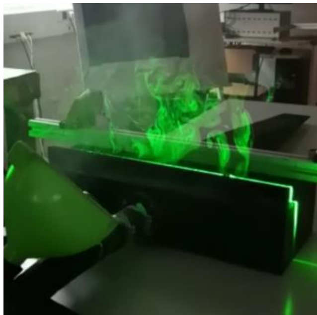
Figura 133. Ensayo del eyector por PIV
