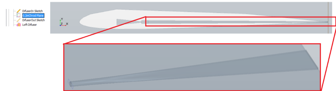
Figura 27. Creación del difusor divergente
