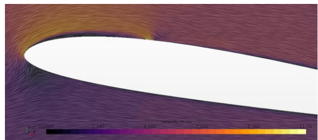
Figura 56. Comportamiento del flujo cuando se succiona al 25% de la cuerda
