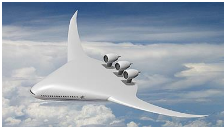
Figura 124. Concepto de motores colocados en la parte de atrás de un fuselaje integrado con el fin de absorber la capa límite del fuselaje [15]
