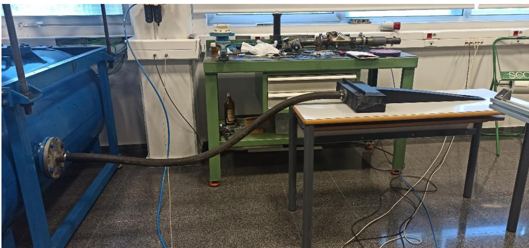
Figura 136. Implantación del eyector en el banco de flujo
