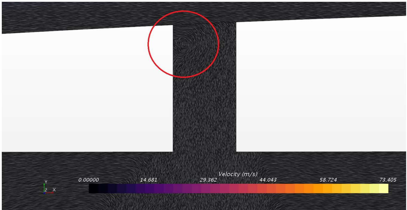
Figura 82. Burbuja de recirculación a la entrada del slot de succión
