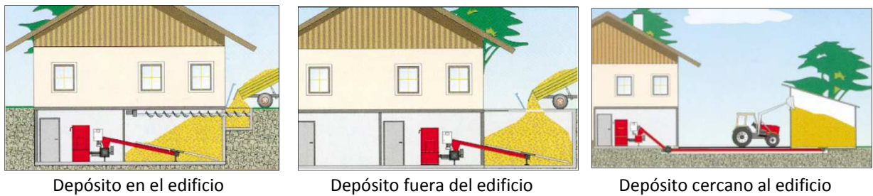
Fig. 65 Posibles posiciones del depósito de combustible (IDAE, 2012) [11]
