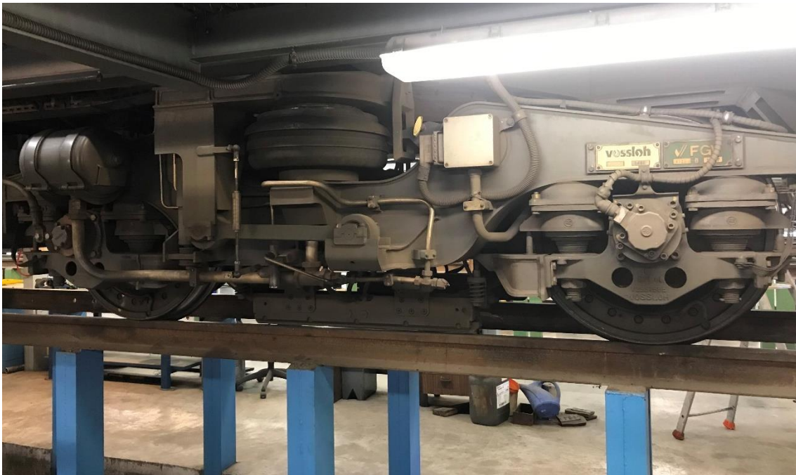
Ilustración 17 - Vista lateral bogies en foso. Serie 4300. Taller València Sud. Fuente: elaboración propia.
