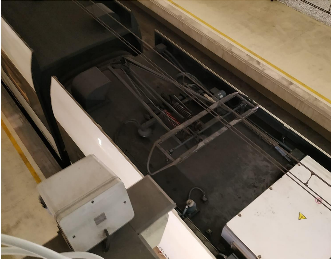
Ilustración 14 - Vista en planta banda de contacto del pantógrafo. Estación de Alameda. Fuente: elaboración propia.
