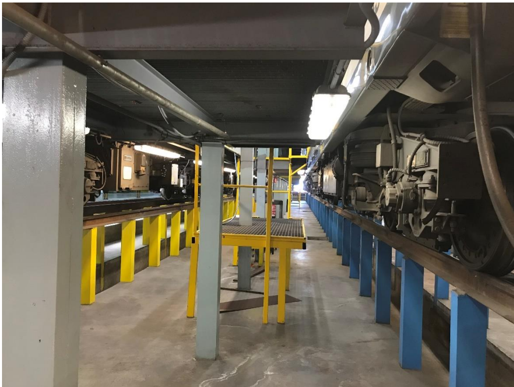
Ilustración 11 - Foso de Talle València Sud para revisión de bogies, rueda y remolque. Fuente: elaboración propia.
