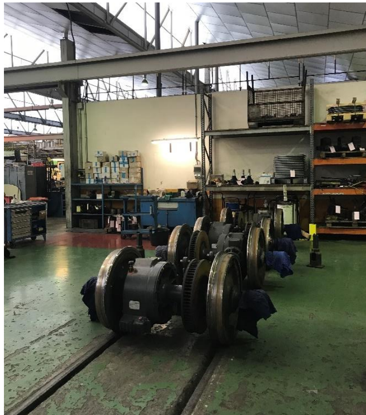
Ilustración 13 - Bogies desmontados para revisión de tipo larga. Taller de Mantenimiento Valencia Sud. Fuente: elaboración propia.
