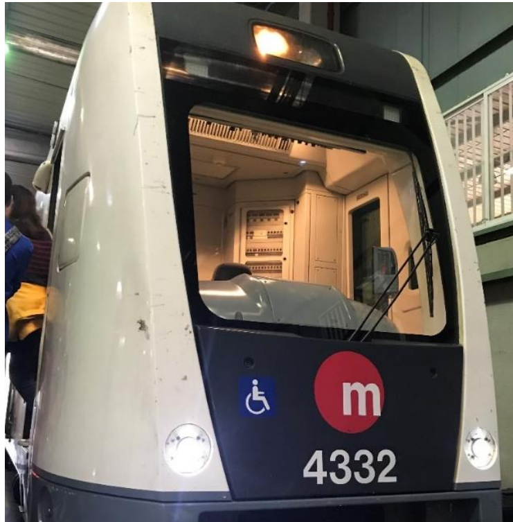
Ilustración 18 - Vista frontal limpiaparabrisas tren Serie 4300. Fuente: elaboración propia.
