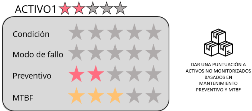
Figura 18 - Valoración activos no monitorizados basados en mantenimiento preventivo y MTBF. Fuente: Smart Motors.
