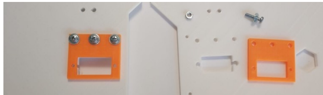
Ilustración 45 Colocación del soporte para los servos.
