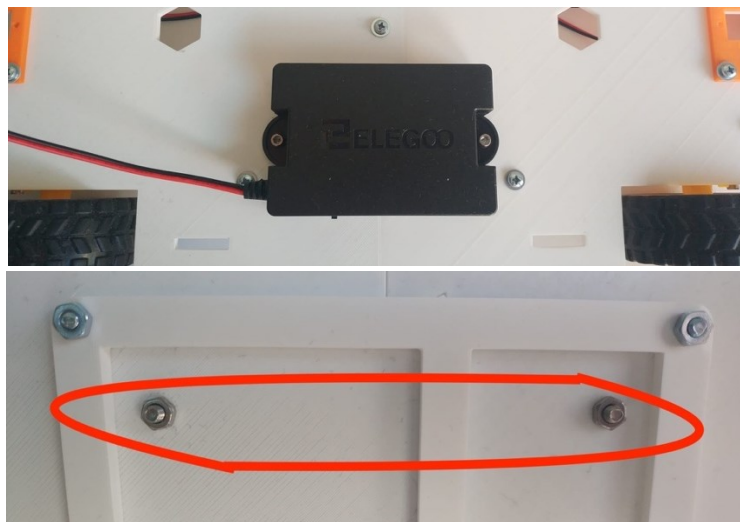
Ilustración 53 Vista superior e inferior del acople de la batería a la base.
