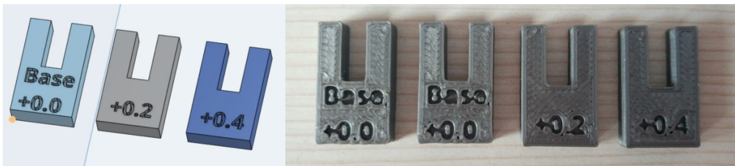
Ilustración 32 Piezas para pruebas de tolerancia de impresión.
