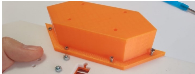
Ilustración 46 Colocación del soporte para el sensor de seguimiento de línea.
