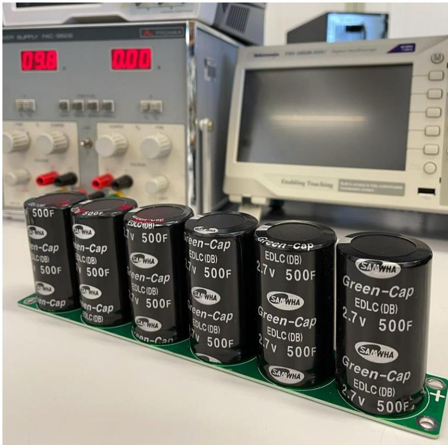
Figura 6: Montaje de la placa balanceadora y los Supercondensadores
