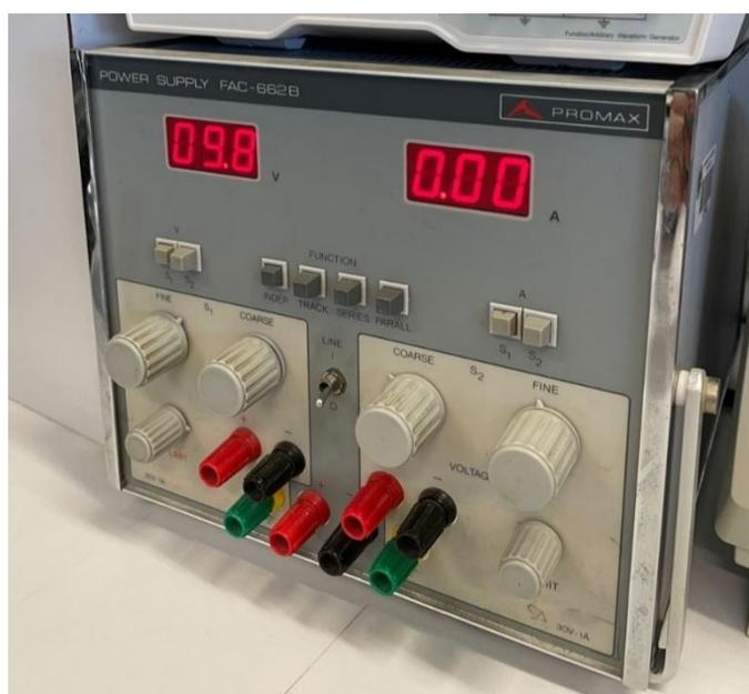
Figura 13: Fuente de alimentación modelo Power Supply FAC-6628 de PROMAX (Valencia, España).
