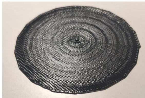
*Ilustración 52. Filtro de 80 mm de radio y 1,3 mm de altura impreso en 3D.*
