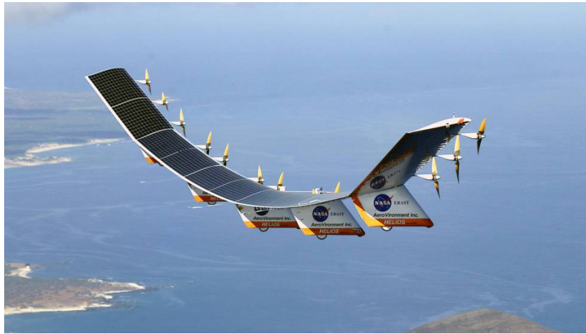
Figura 1.2: Pruebas de avión de vuelo perpetuo fabricado por la NASA para llevar internet a zonas poco pobladas.
