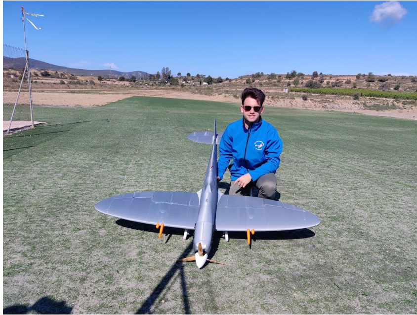
Figura 1.4: Spitfire a escala fabricado completamente con tecnología aditiva.
