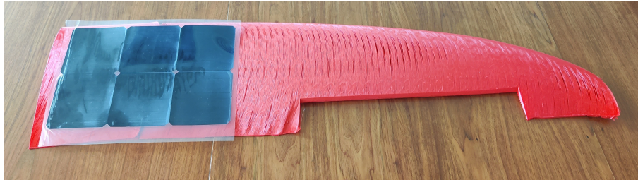
Figura 5.39: Ala del SolarÍO junto a las placas solares en la colocación en la que deberían ir. Todo ello manufacturado con fabricación aditiva en la impresora BlackBelt y el relleno de giroides.
