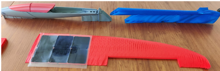
Figura 5.40: Algunas de las partes del SolarÍO fabricadas haciendo uso de la impresora BlackBelt.
