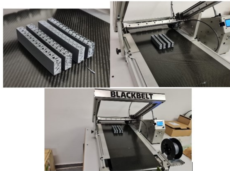
Figura 2.10: Fabricación probetas con relleno de Giroide.
