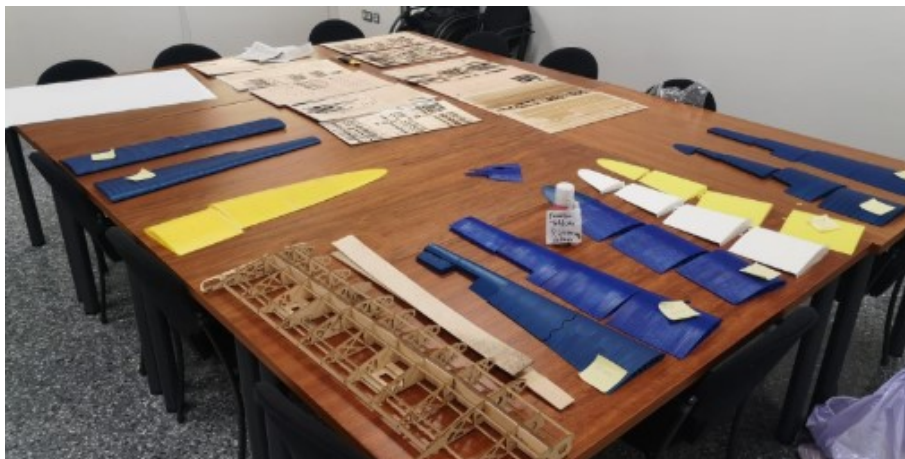
Figura 5.6: Pruebas de manufacturación de diferentes alas haciendo uso de la fabricación aditiva.
