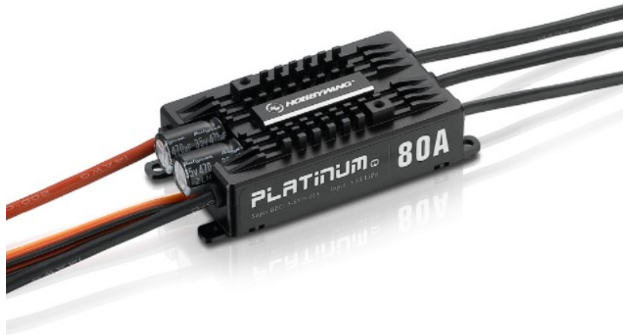
Figura 3.15: Variador de la marca Hobbywing de 80 amperios.
