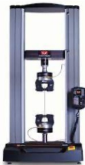
Figura 5.5: Máquina universal de ensayos utilizada para los ensayos
