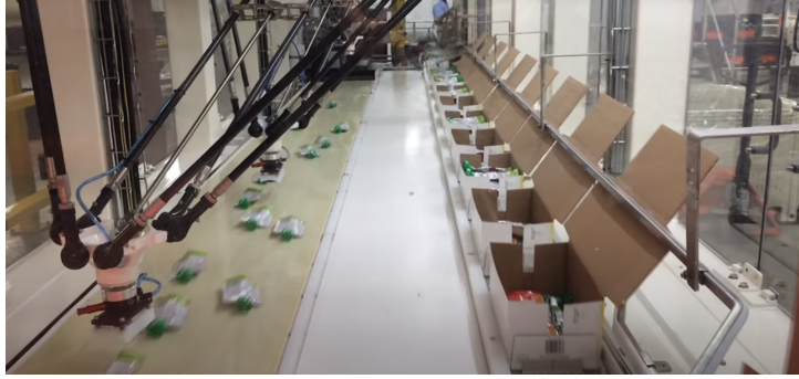
Figura 2.3: Robot Delta empaquetando sobres.
