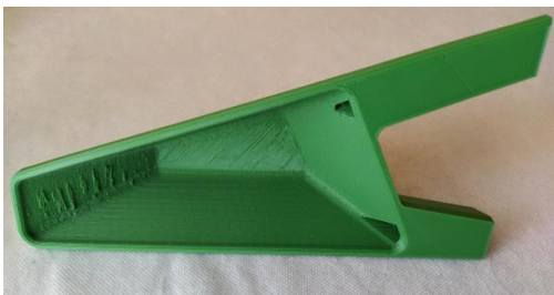
Figura III. 88. Imagen frontal del prototipo impreso en 3D del anclaje del retrovisor B en PLA.
