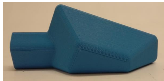
Figura III. 87. Imagen posterior del prototipo impreso en 3D del anclaje del retrovisor A en PLA.
