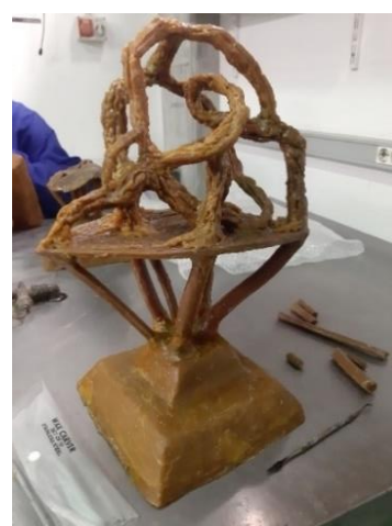
Fig.17. Estela Ferrer. Modelado y realización del árbol de colada.
