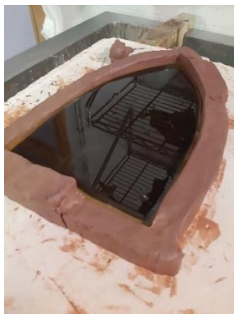
Fig. 14. Estela Ferrer. Molde realizado con barro y una placa de yeso.
