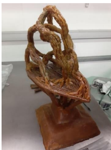
Fig.16. Estela Ferrer. Modelado y realización del árbol de colada.
