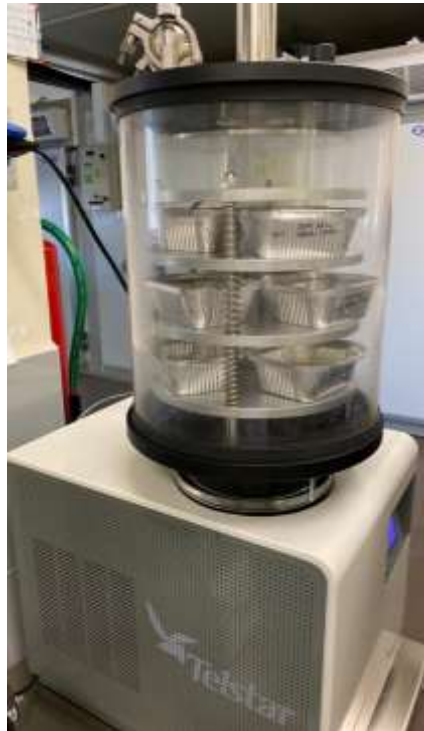
Figura 4. Liofilizador TelstarLioalfa-6 , España, con las muestras en bandejas, listas para liofilizar.
