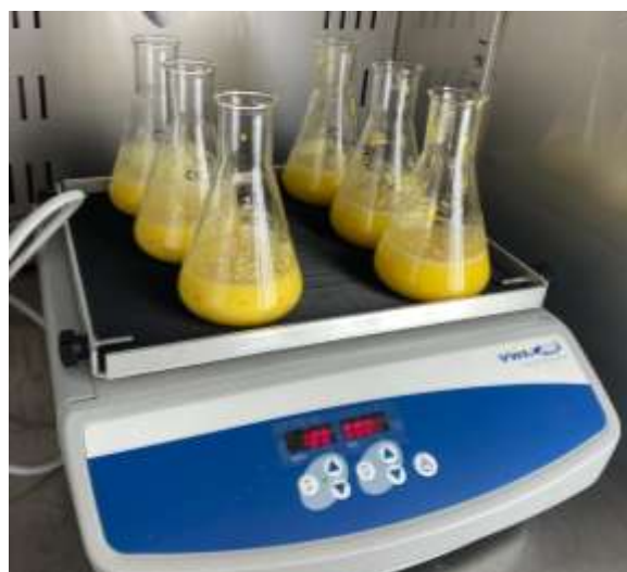
Figura 6. Muestras durante la fase gástrica dentro de la cámara de temperatura controlada.
