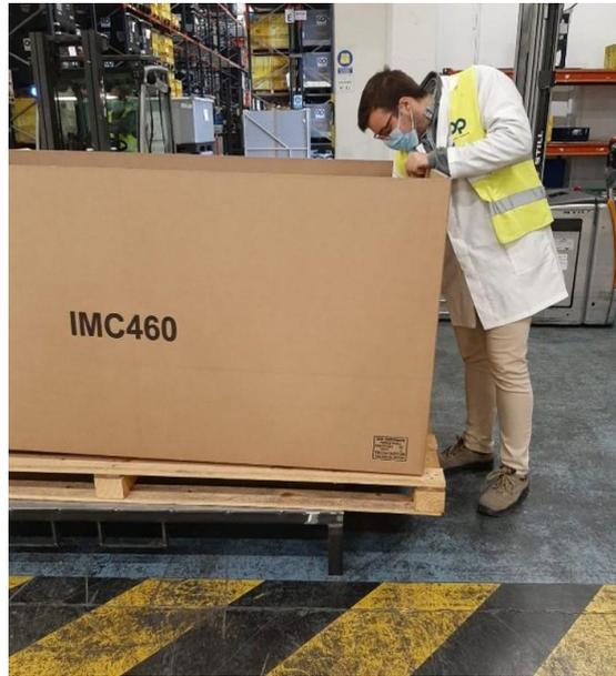
*Ilustración 39. Prueba de la imposibilidad de alcanzar el fondo de la caja encima de la plataforma. - Fuente: elaboración propia*
