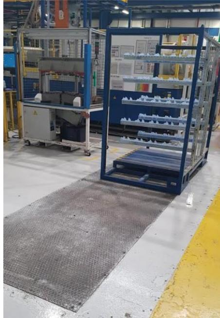
*Ilustración 41. Rack en zona de espera sobre chapa estriada galvanizada. - Fuente: elaboración propia*
