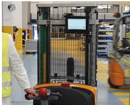
Ilustración 71. Posición de la tablet embarcada. - Fuente: elaboración propia
