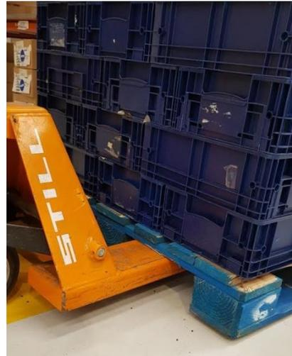
*Ilustración 34. Transpaleta manuela tomando pallet por el lado abierto. - Fuente elaboración propia*
