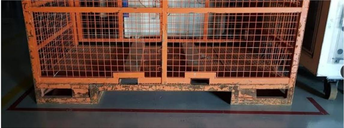
*Ilustración 36. Jaula de scrap modificada para que la pueda coger cualquier medio de manutención - Fuente: elaboración propia*
