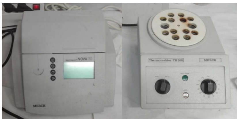
Figura 17. Detalle del espectrofotómetro modelo Spectroquant Nova 30 (izquierda, http://www.laboquimia.es/catalogo/producto.php?codigo=20441097510001 ) y del termorreactor modelo TR 300 (derecha, descatalogado).
