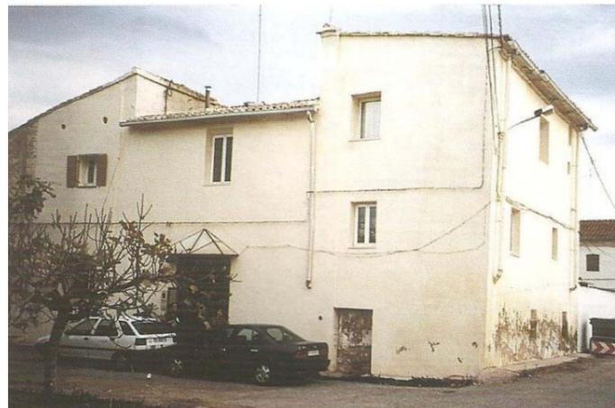
Las dimensiones del edificio principal de la alquería son de 10 m. de profundidad con tres cuerpos frontales: dos laterales de 4,50 de anchura y el central de 7m; la estructura se arriostra cambiando la dirección de los forjados tras el muro central.
